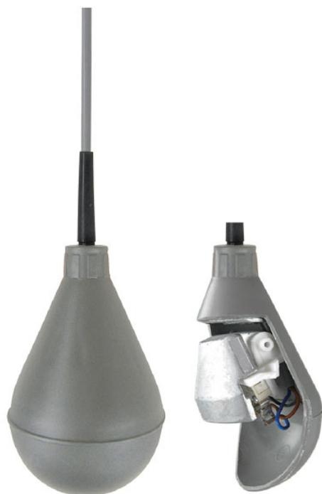
Il galleggiante **Multicontact Sewage- Orange**, contiene un microinterruttore in un sistema a doppia camera. Quando il corpo galleggiante viene immerso in un liquido, il bulbo galleggiante si inclina e attiva il microinterruttore.
