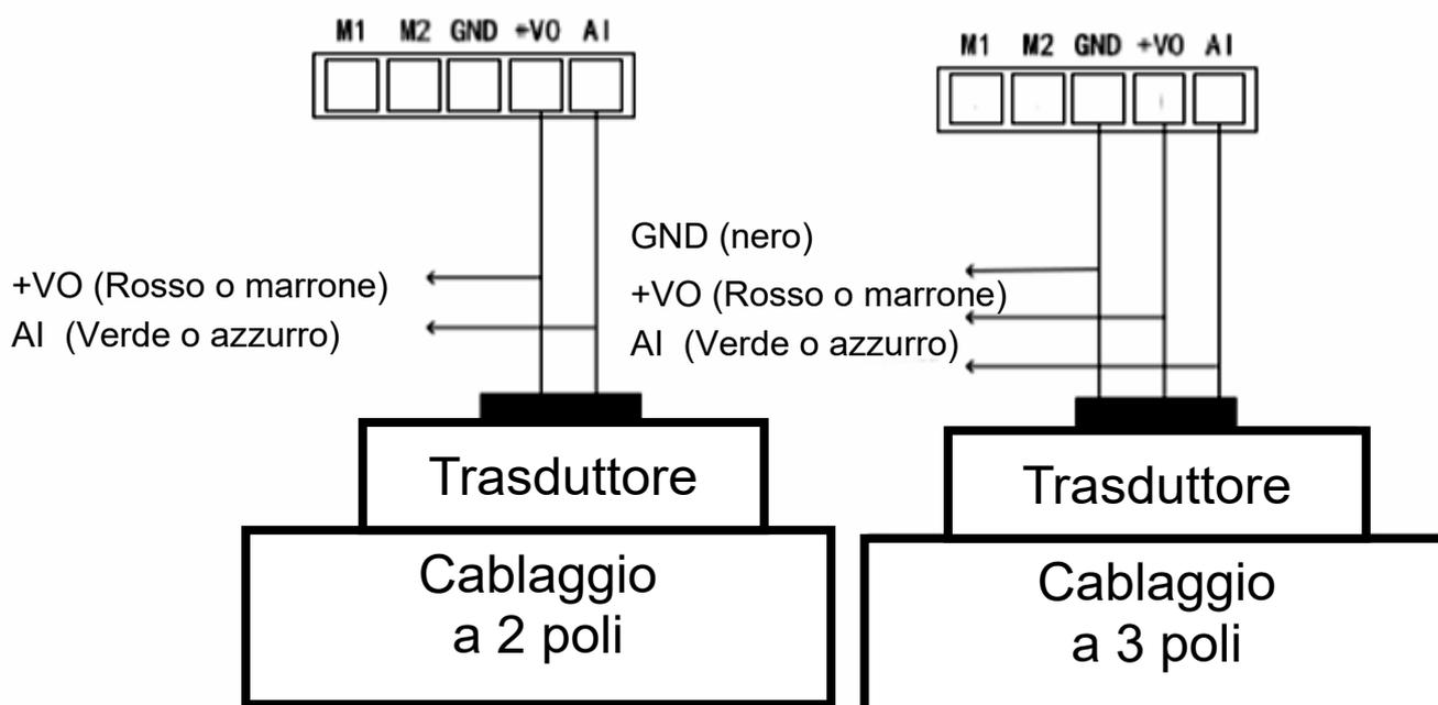
Per utilizzare POWER DATA con i trasduttori forniti dalla casa utilizzare:
