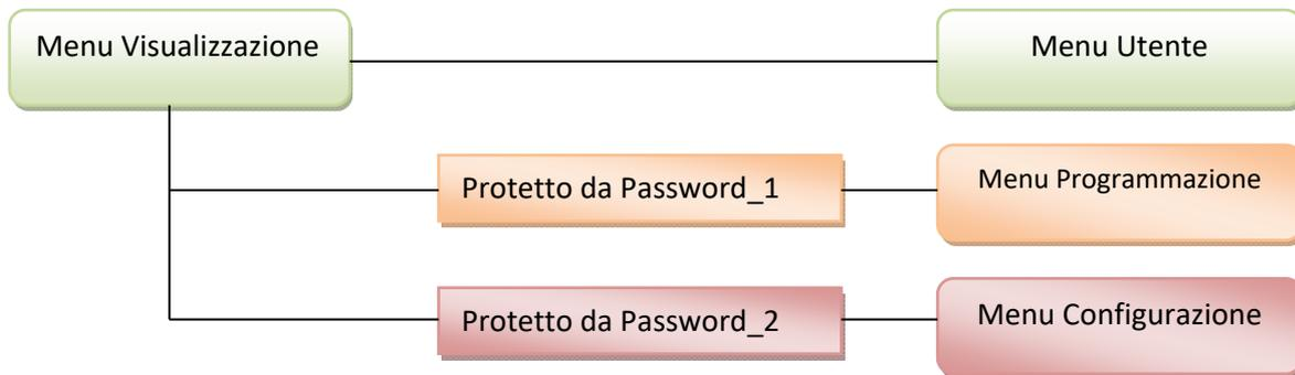
Il menu visualizzazione permette di verificare lo stato di funzionamento dell'apparato.
