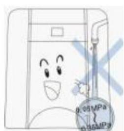
Il funzionamento in condizioni di alta pressione può causare la rottura dei tubi del depuratore. Pressione di ingresso raccomandata: da 0,05 MPa a 0,35 MPa.
