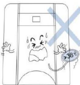
Una temperatura dell'acqua in ingresso superiore a 38 °C, danneggia irrimediabilmente la membrana osmotica.
