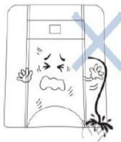
L'occlusione dei tubi di scarico può portare ad un elevato residuo fisso. La membrana dell'osmosi inversa potrebbe bloccarsi e non far funzionare il depuratore.
