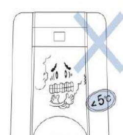
Assicurarsi di mantenerne la temperatura dell'ambiente sempre al di sopra dei 5°C. Temperature troppo basse possono danneggiare il dispositivo.
