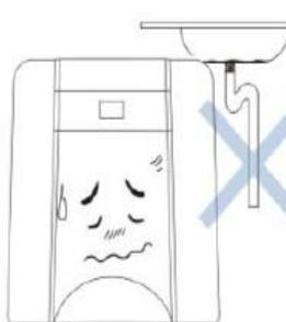
Un utilizzo con la rete fognaria bloccata, potrebbe causare il reflusso dell'acqua di scarico e l'inquinamento del dispositivo.
