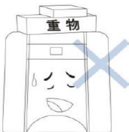
Usare il depuratore come base di appoggio, danneggia gravemente i componenti interni del dispositivo.
