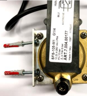
Fig.4-5 – IT- Avvitare la staffa (D) al differenziale di pressione (F) nel lato specularmente opposto a quello con il segno “-“ (cerchiato). EN- Screw the metal bracket (D) to the differential of pressure (F) in the symmetrically opposite side of the one with the “-“ sign (circled). FR- Visser le support (D) sur le différentiel de pression (F) du côté opposé à celui portant le signe “-“ (entouré). ES- Enroscar el soporte metálico (D) en el presostato diferencial (F), en el lado simétricamente opuesto a aquel con el marcador “-“ (señalado en la imagen). DE – Schrauben Sie den Bügel (D) auf der Rückseite der Seite mit dem “-“-Zeichen (eingekreist) an den Differenzdruckregler (F).
