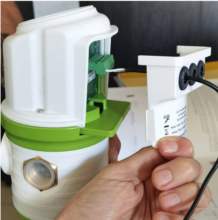
Fig.17 – IT- Riagganciare il carter posteriore di copertura della parte elettronica. EN- Couple the backside of the electronic head cover to the front side. FR- Remettez en place le couvercle arrière de la partie électronique. ES- Acoplar la parte trasera de la unidad de control electrónico
