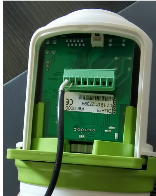
Fig.16 – IT- Reinserrare la morsetteria con i fili appena collegati (Fig.16) nel circuito del filtro. EN- Insert the green terminal block with the wires just connected (Fig.16) into the electric board circuit. FR- Réinsérez le bornier avec les fils que vous venez de connecter (Fig.16) dans le circuit du filtre. ES- Reinsertar el bloque de terminal con los cables que se acaban de conectar (Fig.16) en el circuito del filtro.
